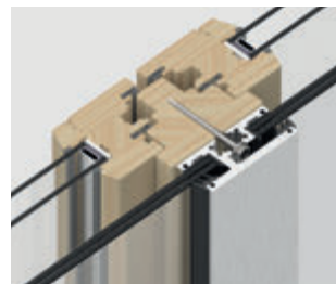
Art-Nr. 7282 Befestigungsvariante A Für Aluminiumfenster (verdeckte Rahmenbefestigung), Holzfenster und Verbundfenster (Holz/Aluminium)
