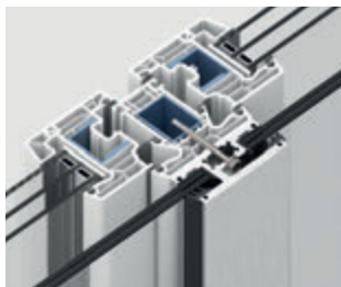
Art-Nr. 7282 Befestigungsvariante K Für Kunststofffenster und Verbundfenster Kunststoff/Aluminium mit Stahlarmierung (verdeckte Rahmenbefestigung)
