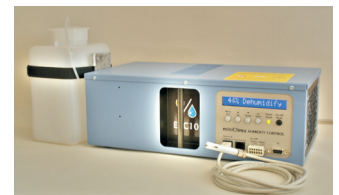
MiniClima: pitää ilmankosteuden vakiona vitriineissä, kaapeissa ja säiliöissä. Suhteellinen ilmankosteus on säädettävissä 28...55 % eikä se vaikuta lämpötilaan. 38.EBC10 3 m 3 saakka 38.EBC11 5 m 3 saakka 38.EBC12 10 m 3 saakka Laitteita voi ketjuttaa ja ilman voi jakaa useampaan tilaan. Tilantarve P 550 L 420 K 220 mm
